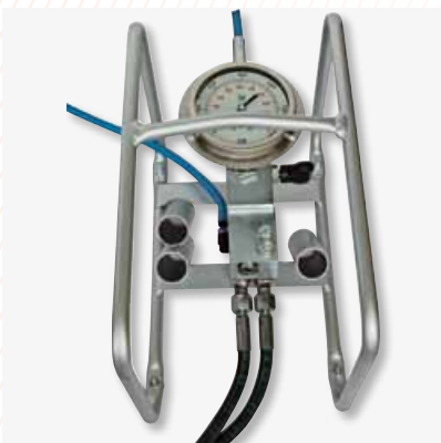
Modularer Druckverstärker: Für den Einsatz von hydraulischen Dehnzylindern bis 1.500 bar, optional 1.800 bar bei Verwendung von Standard-Pumpen bis 700 bar. Schnell und einfach anschliessbar
