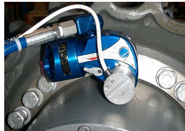
MXT-3 zur Montage nach Drehmoment-Drehwinkel am Raupenantrieb
