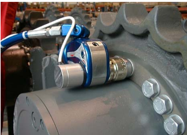
MXT-3 zur Montage nach Drehmoment-Drehwinkel am Raupenantrieb
