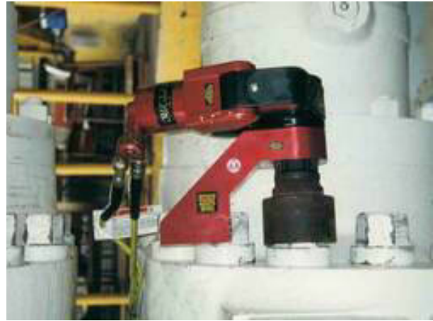
HYTORC-XLCT mit dem patentierten Vierkant-Antriebssystem - auch für DISC und CLAMP einsetzbar
