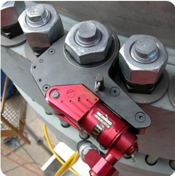
XLCT2-SIMULTORC mit DISC am BASF-Behälter
