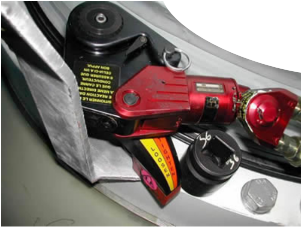
HYTORC-XLCT mit dem patentierten Vierkant-Antriebssystem - auch für DISC und CLAMP einsetzbar
