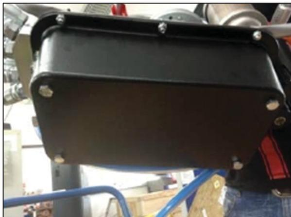
c) Ausgestattet mit einer Plastikfernsteuerung FBP-A5 Art.-Nr.: 31044774 oder FBP-A10 Art.-Nr.: 33150200. Diese Kunststoff-Fernbedienung hat als einzige die Ladungs- und Kapazitätsprüfung bestanden.
