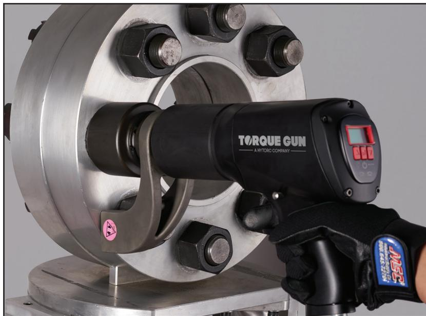
9. Stellen Sie sicher, dass das gewünschte Drehmoment auf dem jGUN-Bildschirm angezeigt wird.
