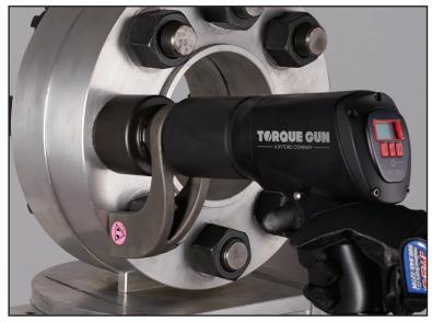
Durch Nutzung der Unterlegscheibe HYTORC Washer™ werden externe bewegliche Teile eliminiert und die Arbeitssicherheit erhöht. Schauen Sie in die Übersicht über HYTORC Washer.
