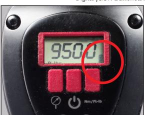
Digital jGUN Batterieanzeige und USB-Anschluss
