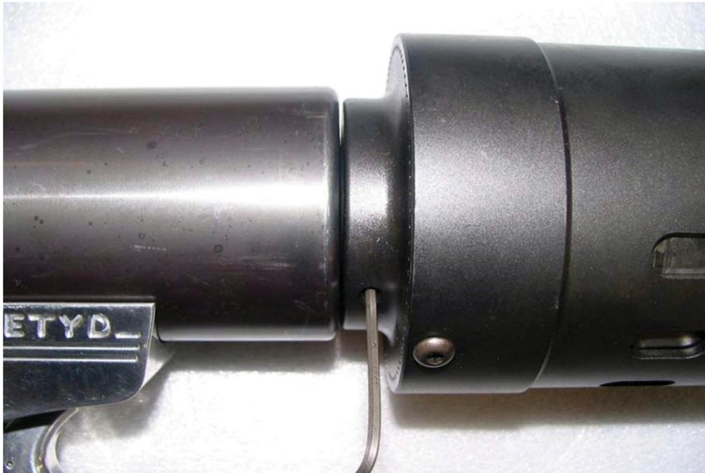
9. Stecken Sie den HYTORC-Disc-Antrieb mit der zweischaligen Stecknuss auf Mutter und HYTORC-Disc. Der Richtungsschalter am jGun-Schrauber muss sich in Position „T“ (Anziehen) befinden.
