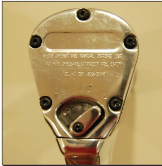
3. Stellen Sie vor Betrieb des Schraubers sicher, dass der Hebel ganz links bzw. ganz rechts sitzt.
