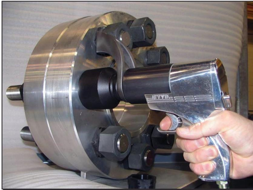
4. Stellen Sie sicher, dass die Drehrichtung des Schraubers richtig für das Lösen eingestellt ist.
