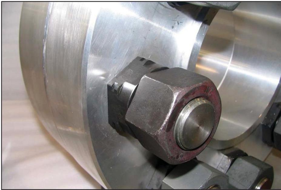
5. Montieren Sie nun die geschmierte Mutter, indem Sie sie so lange im Uhrzeigersinn anziehen, bis sie handfest an der HYTORC-Disc aufliegt.
