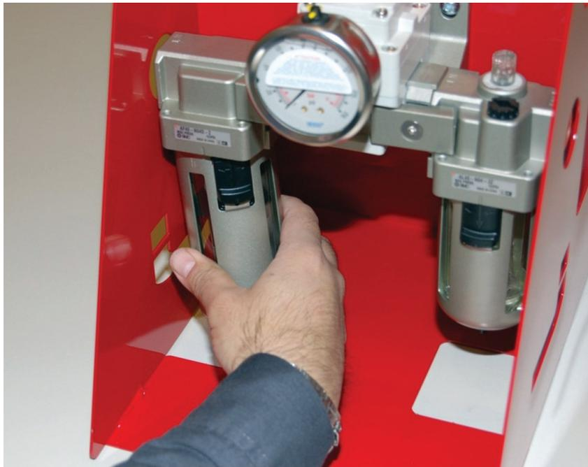
Abbildung 17: Schmiervorrichtung der FRL-Unit zu 2/3 mit Öl befüllt
