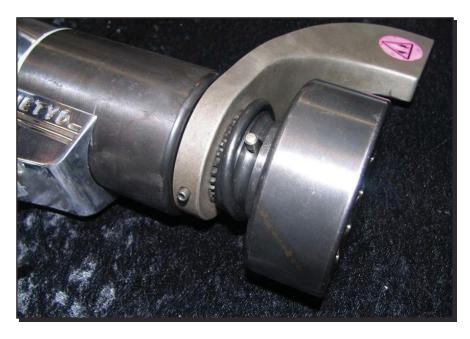
Abbildung 7: Montage von Sicherungsstift und -ring der Stecknuss
