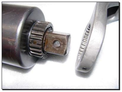
Abbildung 3: Montage des Reaktionsarms
