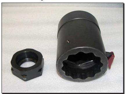
Abbildung 20: Disc und Antrieb von HYTORC
