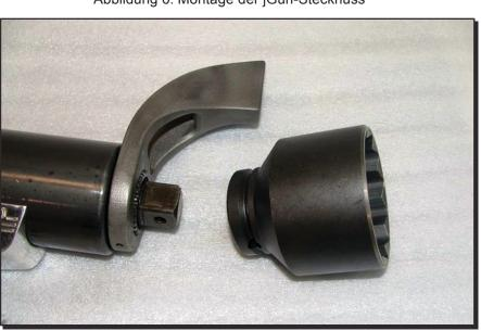
Abbildung 6: Montage der jGun-Stecknuss
