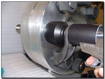
Abbildung 8: Positionierung des Reaktionsarms
