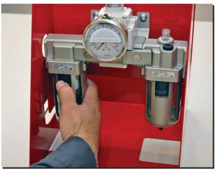
Abbildung 15: Leeren des FRL-Filterbehälters
