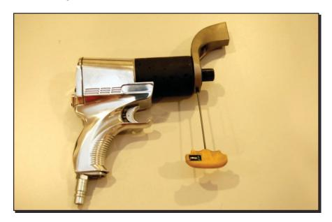
• Setzen Sie eine Stecknuss geeigneter Abmessung auf den jGun-Lauf.
