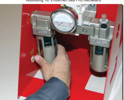
Abbildung 16: Entfernen des FRL-Behälters
