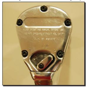
Abbildung 9: Hebel für Antriebsrichtung der jGun
