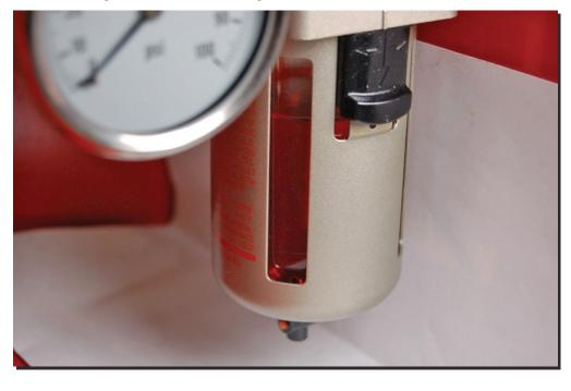
Abbildung 17: Schmiervorrichtung der FRL-Unit zu 2/3 mit Öl befüllt
