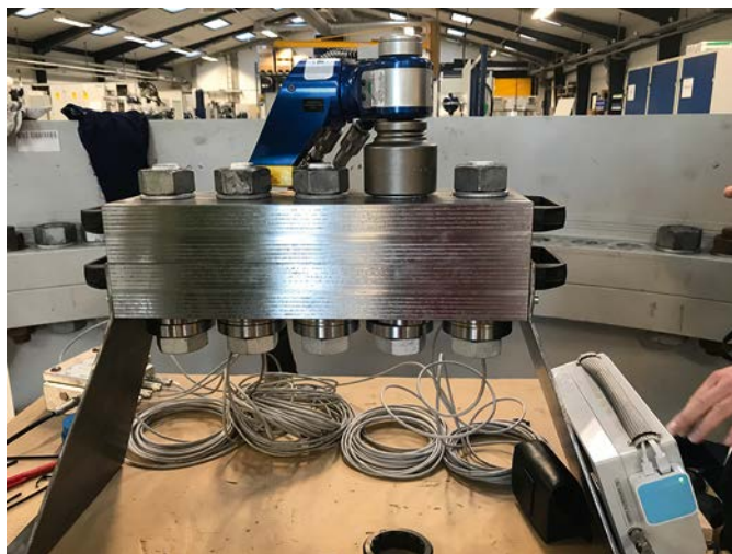
Bild 1. In einem Teststand werden die Vorteile des streckgrenzgesteuerten Anziehens überprüft.
