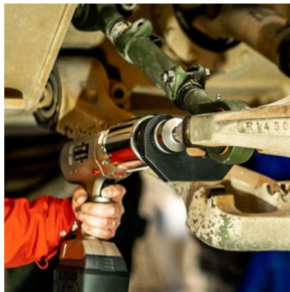
Akku-Drehmomentschrauber für die Instandhaltung militärischer Geräte mit mittlerer bis geringer Risikobewertung MES I
