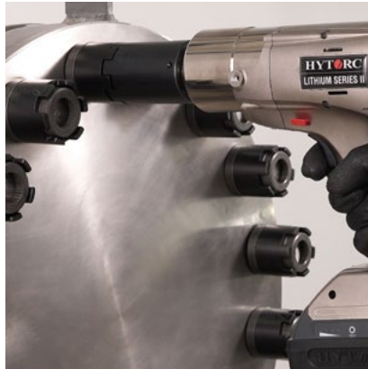
Dehnmutter-Aufsatz kompatibel mit allen HYTORC Vierkantschrauben
